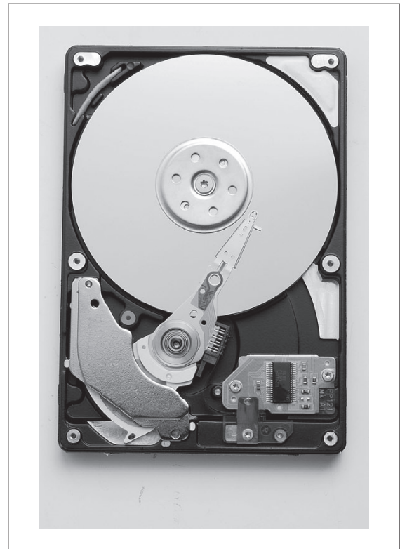
【ハードディスク】内部構造の例
