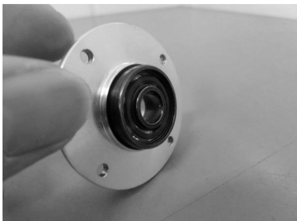
図3 ベアリング組み込み
