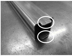
図 8 端面のプラグ形状
