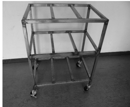
図 22 工具運搬台車フレーム
