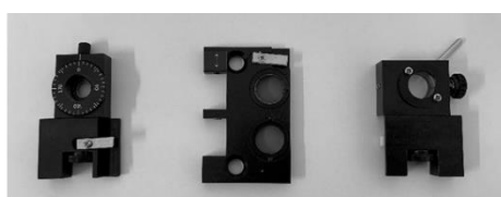
ポラライザ アナライザ スクランブラ 図 3 偏光ラマンユニット
