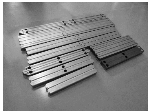
図7 レーザー加工後の角型鋼管
